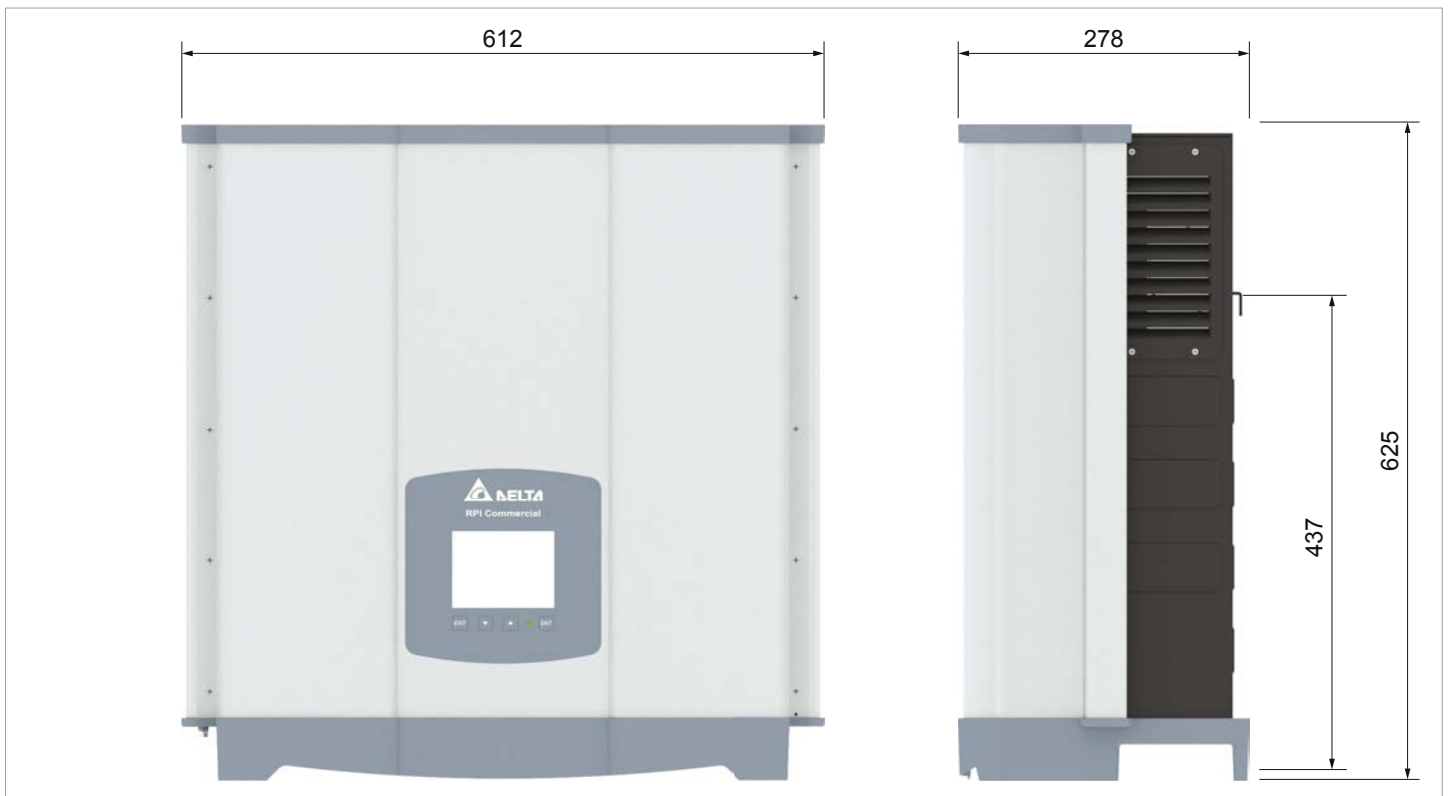
Abb. 6.9: Abmessungen Wechselrichter (in mm)
